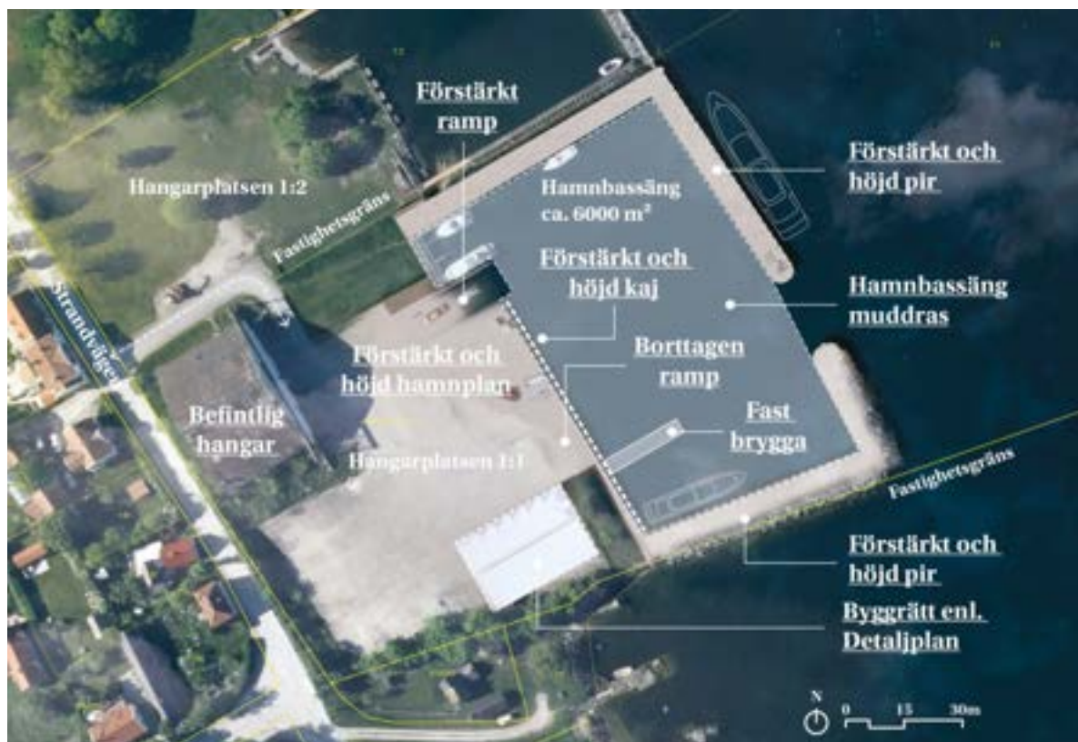
Figur 4.1. Flygbild över fastigheten Hangarplatsen 1:1 med planerade åtgärder (arbetsområdet).
